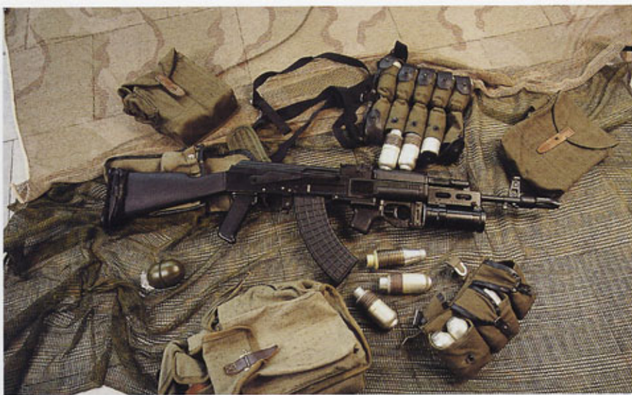
L'AR-M1 calibro 7,62x39 con lanciagranate UBGL, adottato dall'Esercito Bulgaro. Notare il particolare spegnifiama e le granate autopropulse da 40 mm: subito sotto di esso è visibile la granata RHE-FJ (jumping) con la caratteristica spoletta conica, le altre sono RHE-F con spoletta ad impatto.
